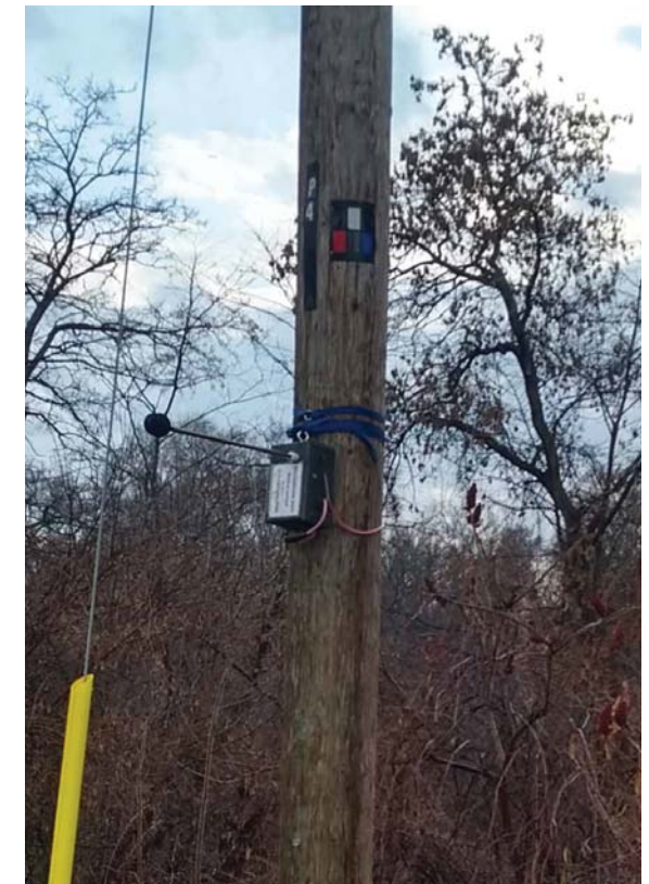
Enregistreur recueillant des mesures de bruit ambiant
