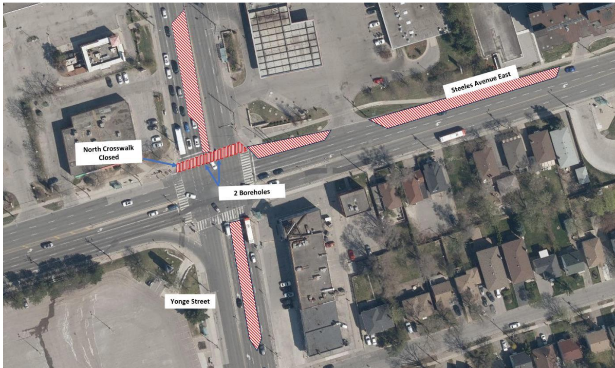
Figure 1 : La zone de travail approximative et les contrôles de circulation pour les travaux d'enquête géotechnique. La carte n'est pas à l'échelle et n'est présentée qu'à titre d'illustration.
