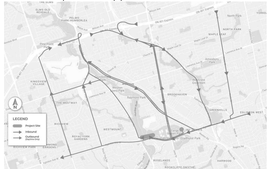
Itinéraires de transport et de livraison majeurs à destination ou en provenance de la voie de guidage et du site de creusement de tunnels.
