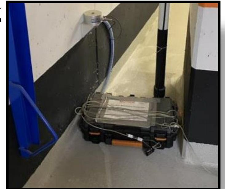
Exemple d'équipement de surveillance des vibrations installé à la gare Union
