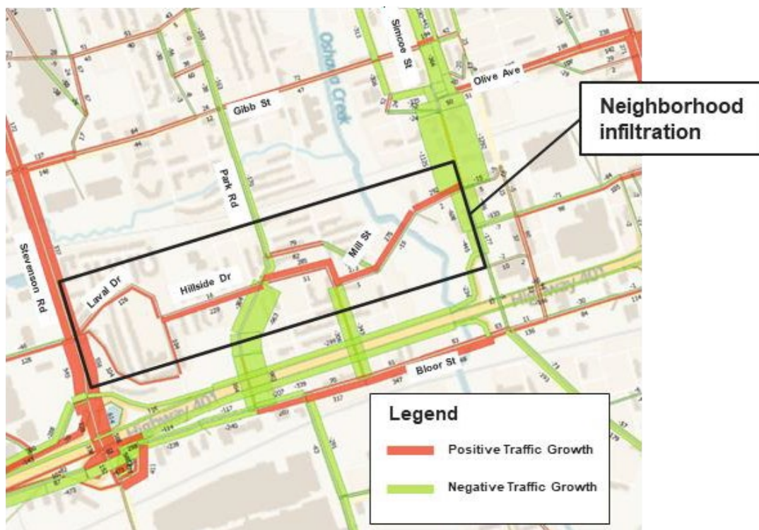
Figure 7.4 : Scénario 2 – Projections de changement de volume de la circulation du MPTRD
