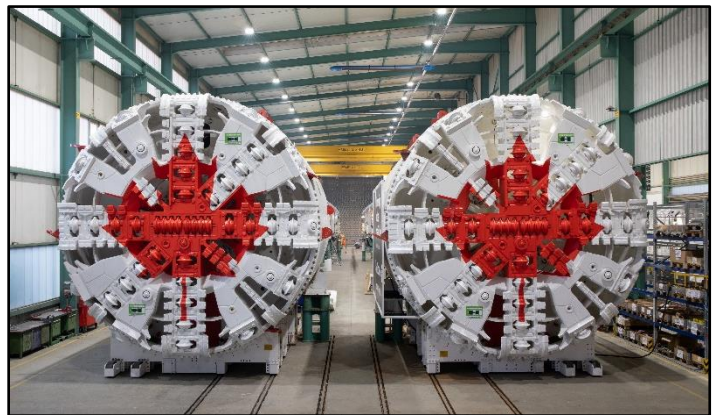
Tunneliers de la ligne Ontario
